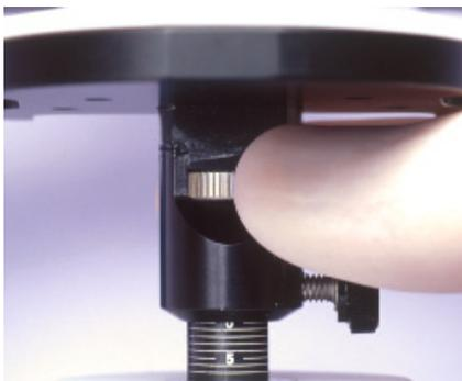
2. Den Modell-Montagetisch des Kois-Systems durch drehen der horizontalen Einstellschraube auf "Null" einstellen
